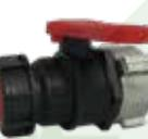
2" IBC PP S60x6 Válvula de bola con junta PTFE, S60x6 rosca macho, palanca roja y tapón negro/rojo. Otro lado: aluminio S75x6 hembra con junta EPDM.
