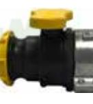
2" IBC PP S60x6 Válvula de bola con junta PTFE, DN50 NPT con rosca macho, palanca amarilla y tapón amarillo. Otro lado: aluminio S75x6 hembra con junta EPDM.
