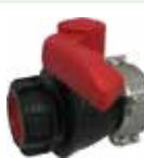
2" IBC PP S60x6 Válvula de bola con junta EPDM, S60x6 rosca macho, palanca roja y tapón negro/rojo. Otro lado: aluminio S75x6 hembra con junta EPDM.
