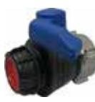
2" IBC PP S60x6 Válvula de bola con junta FKM, S60x6 rosca macho, palanca azul y tapón negro/rojo. Otro lado: aluminio S75x6 hembra con junta FKM.
